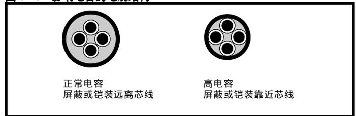
表 6-16 至表 6-19 采用的电缆带屏蔽层，含有 4 根芯线。该类电缆的典型容量为 130 pF/m（即：从一根芯线至所有其他芯线及屏蔽层连接在一起）。
